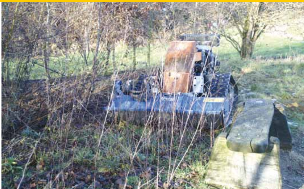
Wolterinck verving bosmaaiers door de radiografisch bestuurbare klepelmaaier.
